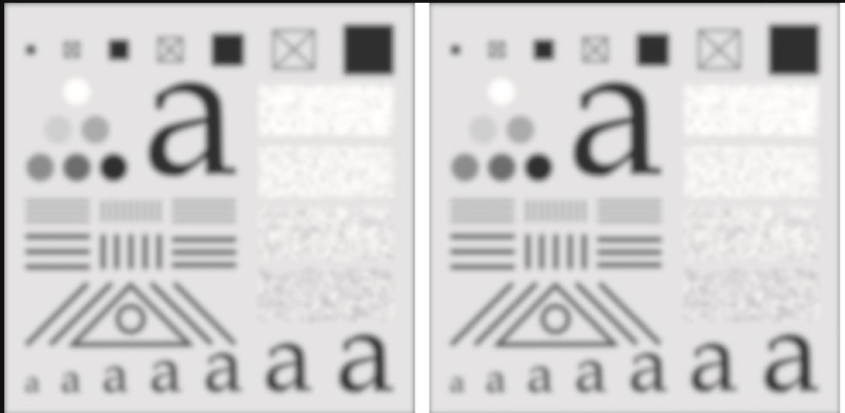
Αποτέλεσμα φιλτραρίσματος με πυρήνα 43x43 και \sigma=7
