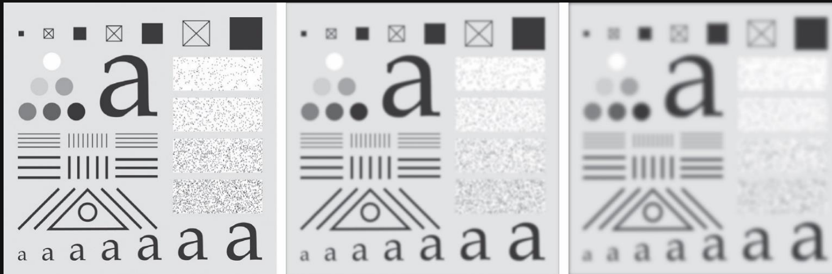
Gaussian filter, 21X21 με \sigma=3.5
